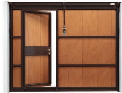
La **porta pedonale per struttura Nature Sikurtec e Dynamic Sikura** è inserita nell'anta mobile. Con apertura a 90°, è realizzata con profilo tubolare perimetrale in lamiera d'acciaio zincata e verniciata, rinforzato orizzontalmente. La porta è dotata di cerniere in acciaio ed è completa di maniglia e placca in alluminio.
