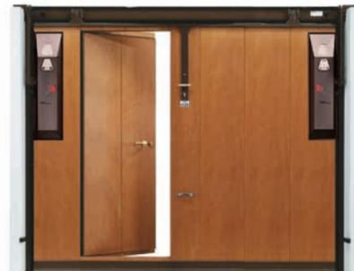
La **porta pedonale per struttura Style Sikurtec e Reserve Sikura** è inserita nell'anta mobile. Con apertura a 90°, è realizzata con profilo tubolare perimetrale in lamiera d'acciaio zincata e verniciata, rinforzato orizzontalmente. La porta è dotata di cerniere in acciaio, totalmente a scomparsa. **A richiesta è possibile installare una serratura a tre punti di chiusura con chiave a doppia mappa per garantire una maggiore sicurezza antieffrazione.**
