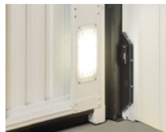
Coppia di luci a led, ad alta intensità, integrate nell'anta mobile e precablate, adatte per illuminare la zona di transito durante la manovra. (cod. MB.36) (optional)
