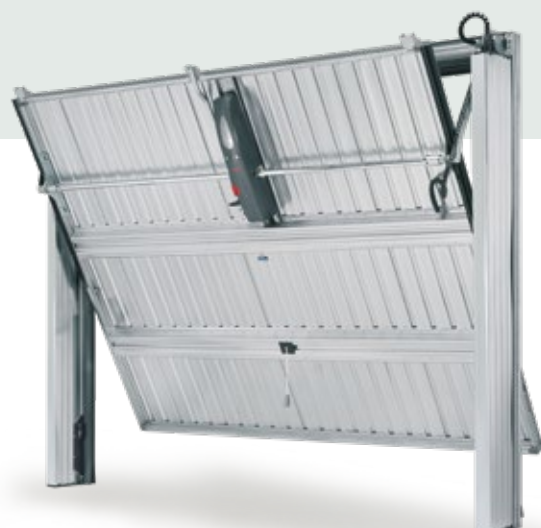
Vista interna Zink Spazio HF con automazione SIM-1. L'automazione SIM-1 prevede un motore centrale applicato su un longherone centrale (posto sull'anta mobile) con base motore e tubi di rinvio. La coppia di fotocellule interne premontate e precablate è optional.
