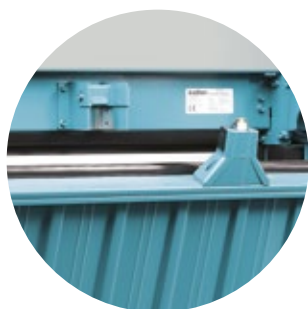
Particolare dello scrocco di chiusura laterale inserito nel dispositivo autocentrante.
