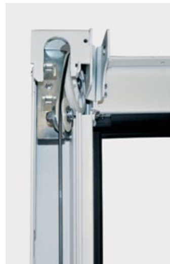
La dimensione delle carrucole di rinvio garantisce lunga durata alla fune in acciaio e un corretto posizionamento del contrappeso.
