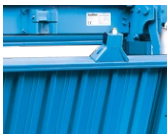
Particolare vista interna serratura con due punti di chiusura per strutture Sikura.
