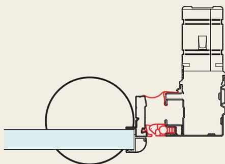
Sezione profilo anta mobile con bordo arrotondato, di serie nelle porte basculanti MyFusion.
