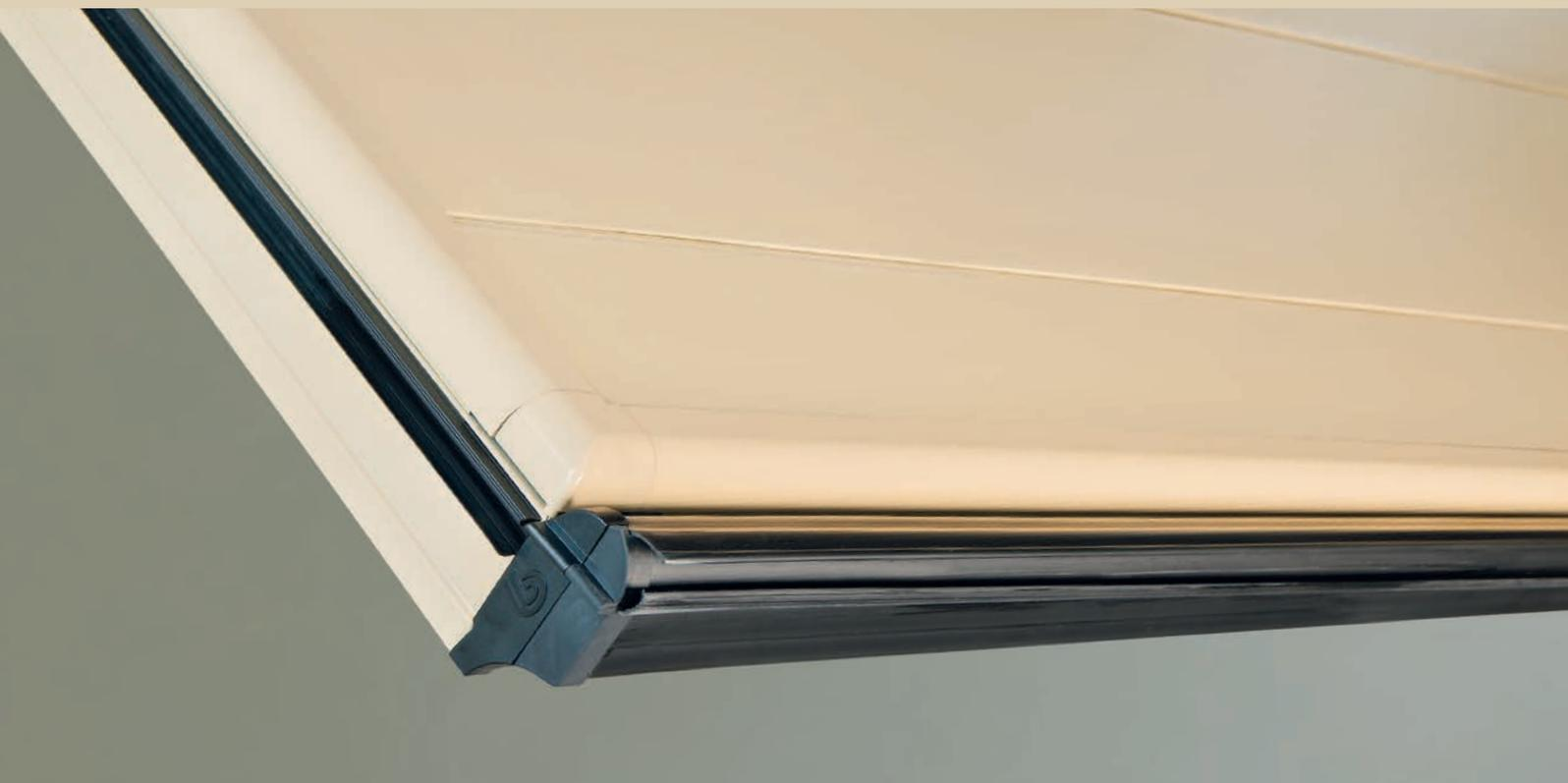
La zoccolatura inferiore in abs nero (optional per MyFusion) ha una altezza di 50 mm, un profilo di alluminio all'interno e tappi laterali di chiusura. Garantisce una perfetta chiusura tra anta mobile e pavimento, con un risultato estetico pregevole.
